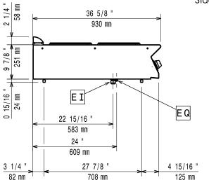
Electrical inlet (power) Equipotential screw
