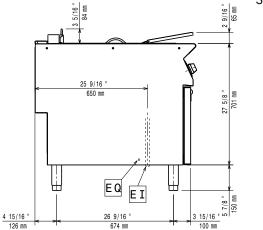
ΕI Electrical inlet (power) Equipotential screw EQ
